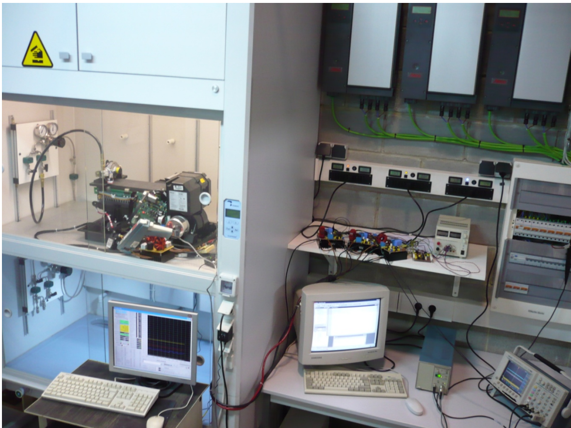
Figura 86. Connexió de la pila de combustible als convertidors elevadors.
