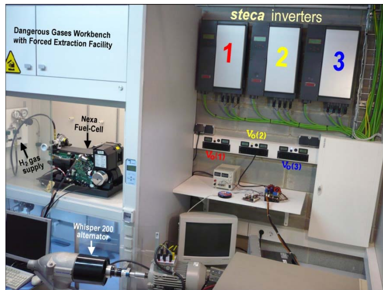
Figura 3. Pila Nexa, Aerogenerador Whisper 200 i un circuit adaptador per una altra font d'energia (pila H2-Economy de 4.2V i 100W).
