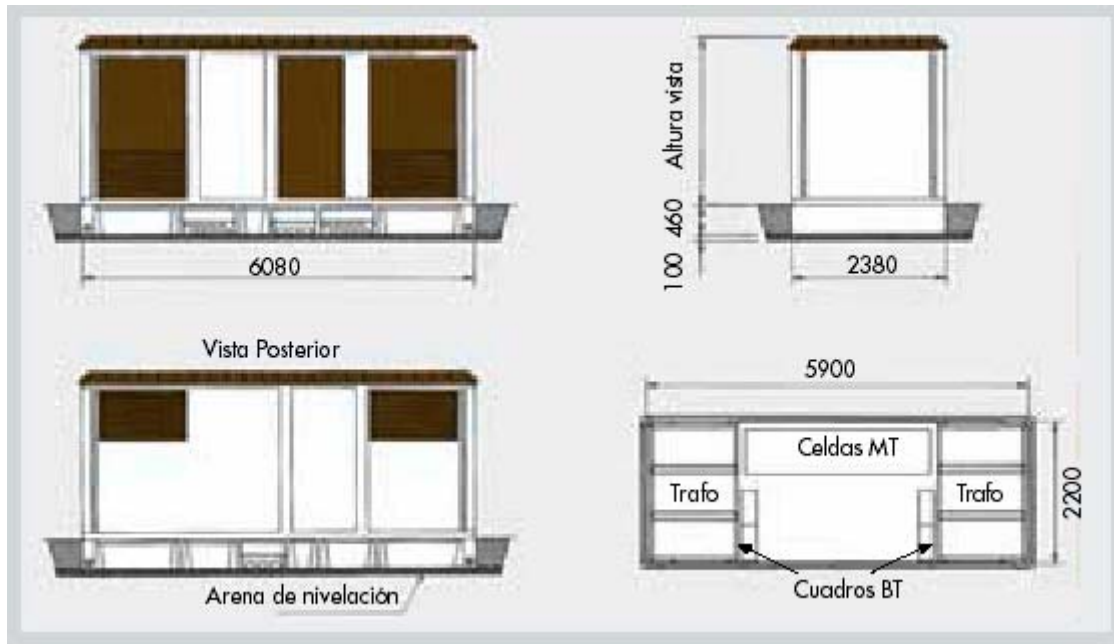
- Figura 3. Medidas del centro de transformación-
