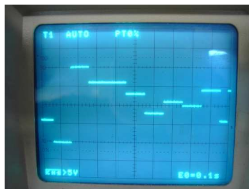
Figura 9.42: Función personalizada de periodo 1s y tipo de cambio pulsante. Osciloscopio en la salida.
