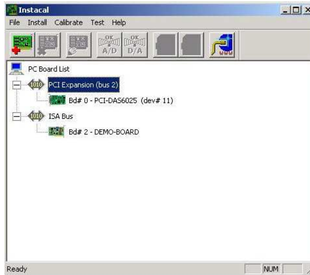
Figura 10.3: Instalación de la tarjeta PCI DAS6025 paso 2 de 2.
