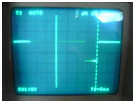
Figura 9.10: Función cuadrada de 10v de amplitud, -4v de offset, 50Hz de frecuencia y un ciclo de trabajo del 70%. Osciloscopio en la salida.
