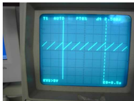
Figura 9.20: Función diente de sierra de 4,5 v de amplitud, 0,5 v de offset, tiempo de subida de 500ms y tiempo de bajada nulo. Osciloscopio en la salida.
