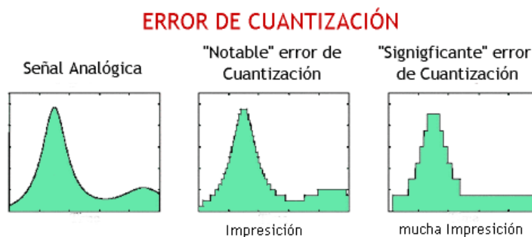
Figura 4.3: Errores al digitalizar una señal
