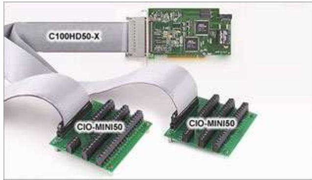
Figura 6.4: Ejemplo de la conexión de la tarjeta PCI DAS6025 con las 2 CIO-MINI50 mediante un cable C100HD50-X
