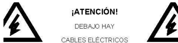
Figura 6.1: Marcat cinta senyalització de cable enterrat
