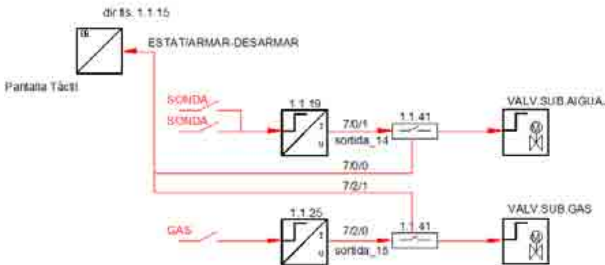
Figura 46. Diagrama Funcional. Control per Detectors- Alarmes Tècniques
