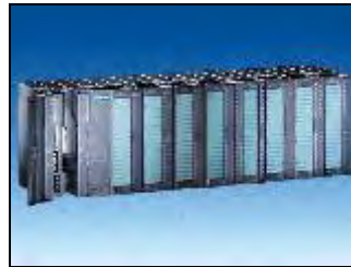
Figura 121: Rack del ET-200M
