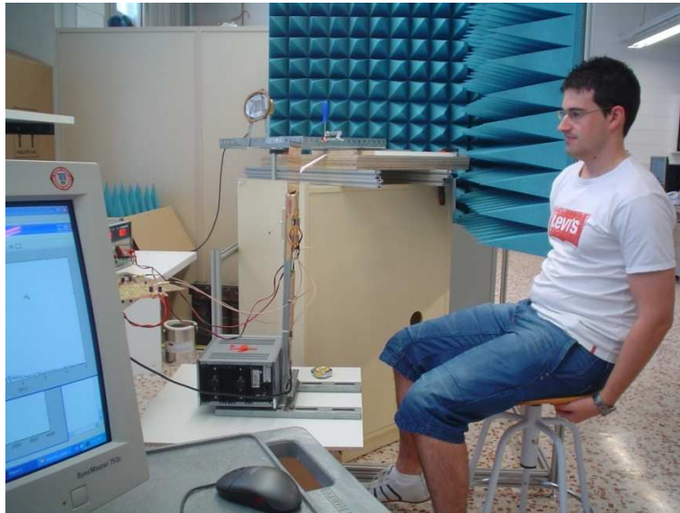
Figura 90: Muntatge per a la detecció de la freqüència de respiració d'una persona
