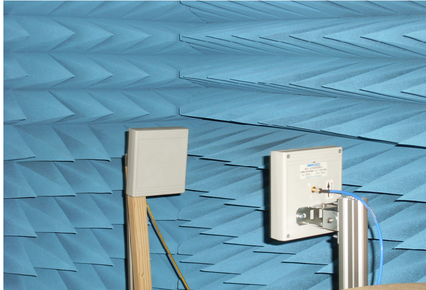
Figura 3.9 Mesura de la resposta temporal amb antenes Geozondas.
