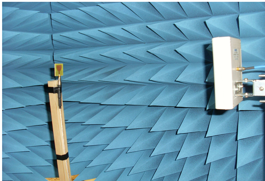
Figura 3.10 Mesura de la resposta temporal de l'antena rectangular escalonada.
