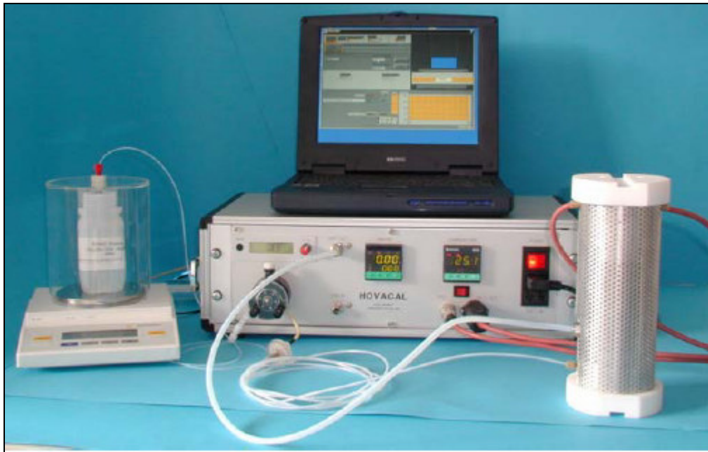
Figura 8.1. Evaporador de Gases
