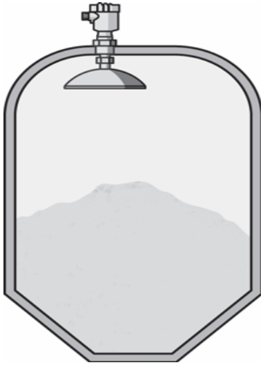
Figura 8. Ubicación sensores de nivel silos
