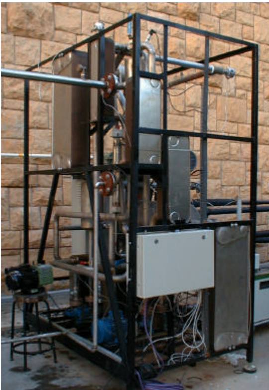
Fig. 6.2 Detalle lateral del prototipo una vez instalado en el banco de ensayos
