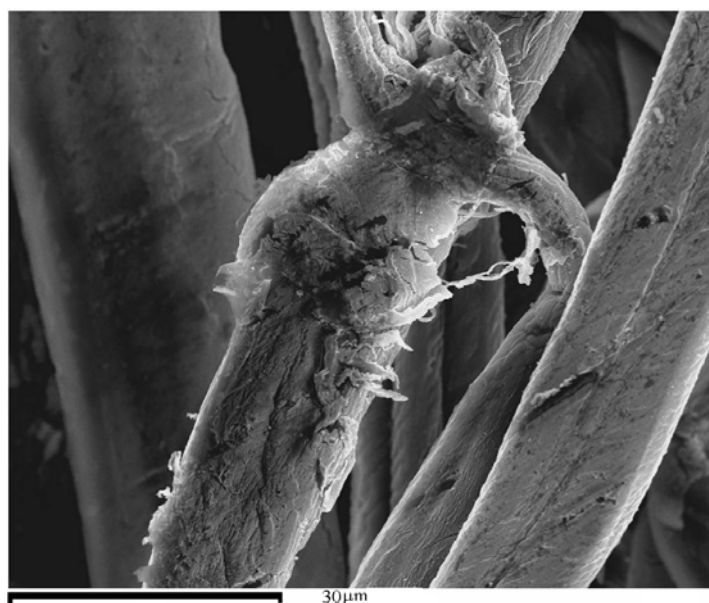
Figura 4.23 Micrografía de Miscanthus sinensis cocido a 200°C y 3 min. (x1500) (Se pueden observar el daño en la fibra por la cocción a alta temperatura)
