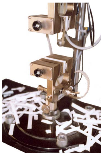
Figura 5.2. Equip Zwick, model 1445 per proves de tensió.
