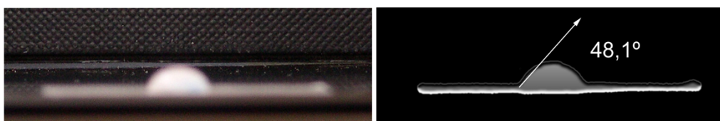
Figura 4.3. (a) Imatge d'una gota sobre la superfície d'una membrana obtinguda amb 20% de PSf en DMF i amb un bany de coagulació (b) Mateixa imatge filtrada per determinar l'angle de contacte.
