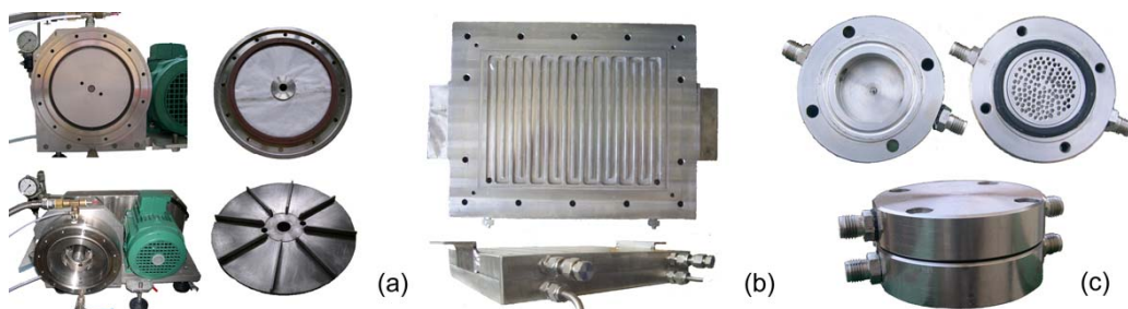
Figura 6.1. Mòduls de membrana usats: (a) Mòdul rotatori, (b) Mòdul serpenti i (c) Mòdul circular.
