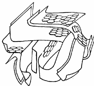
Figura 2.3. Representación esquemática típica de la microestructura del AC.
