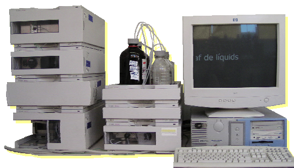
Figura 4.28. HPLC: Cromatógrafo de líquidos Agilent 1100 Series.
