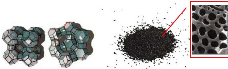
Figura 1.1. Ejemplos de estructuras de zeolitas (derecha) y materiales carbonosos (derecha) con estructura porosa desarrollada.
