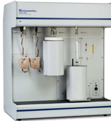
Figura 4.17. Equipo de medida de superficie ASAP 2020.
