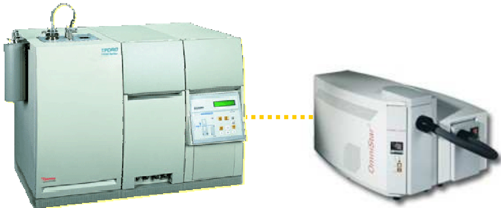
Figura 4.23. Equipo para análisis de TPD Termo Finnigan modelo TPDR 1100 (izquierda) conectado a un analizador de masas Pfeiffer Vacuum Omnistar modelo GSD 301 O (derecha).
