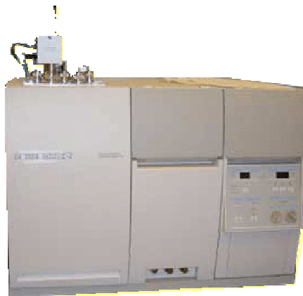
Figura 4.8. Analizador elemental Carlo Erba modelo CHNS-O EA1108, provisto de automuestrador.
