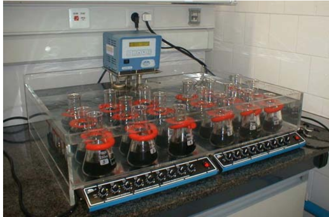
Figura 4.27. Sistema de análisis empleado para la adsorción de metales.
