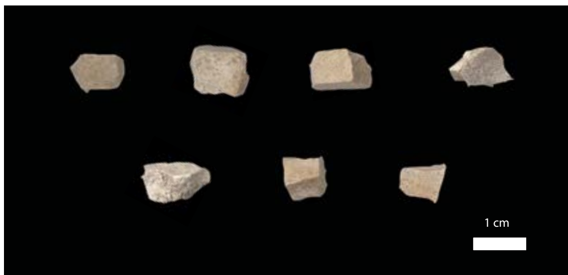
Figura 4.9 Muestras preparadas a partir de un hueso de la Cala 1 del Barranc de la Boella para los ensayos de dureza y penetración
