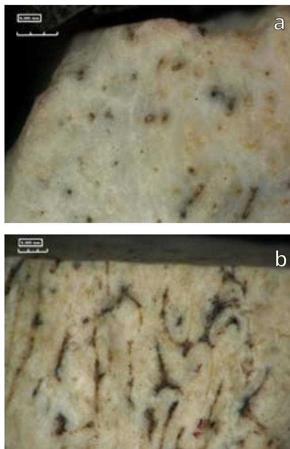
Figura 8. 6. Sección de las muestras tras la consolidación con DAP
