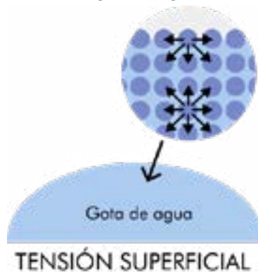
Figura 3.6. Esquema de la tensión superficial en las moléculas de agua. Ilustración realizada por Elisa Díaz Cortés.
