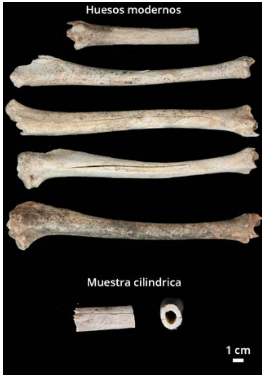
Figura 4. 1. Huesos modernos, en este caso son tibias de oveja. Abajo se expone el tipo de cilindro que se obtuvo cortando las epífisis de estos huesos y que serían las muestras utilizadas.
