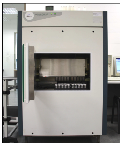
Figura 2.17. Detector d'escintil·lació líquida (Perkin Elmer).
