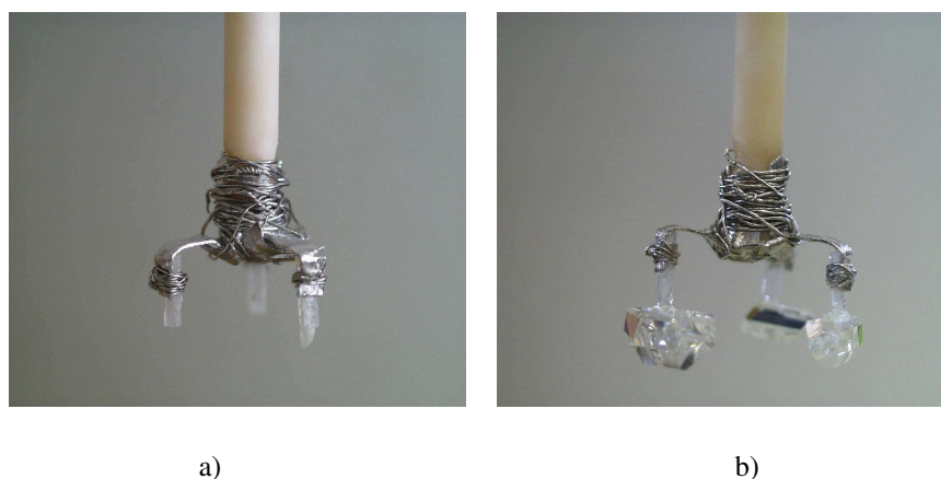
Figura 4.3 a) Gérmenes de KYW en dirección cristalográfica b atados a un soporte de Pt unido a una caña de alúmina, b) Substratos de KYW crecidos en la dirección cristalográfica b
