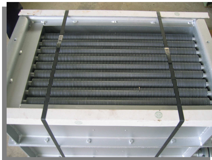
Figura 3-18. Foto de la parte superior del intercambiador de calor de aceite térmico.
