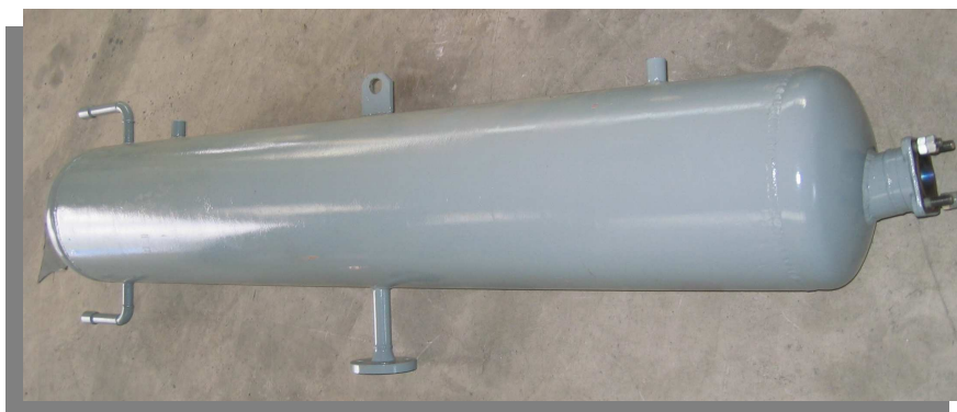
Figura 3-27. Vista exterior del depósito de expansión para aceite térmico.
