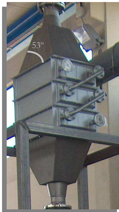
Figura 3-22. Vista exterior del intercambiador de calor de aceite ya montado en la estructura de sujeción.
