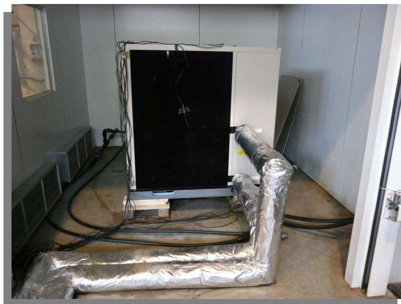
Figura 4-38. Enfriadora por absorción en el interior de la cámara climática con medición de temperatura ambiente en la superficie mediante sondas PT100.
