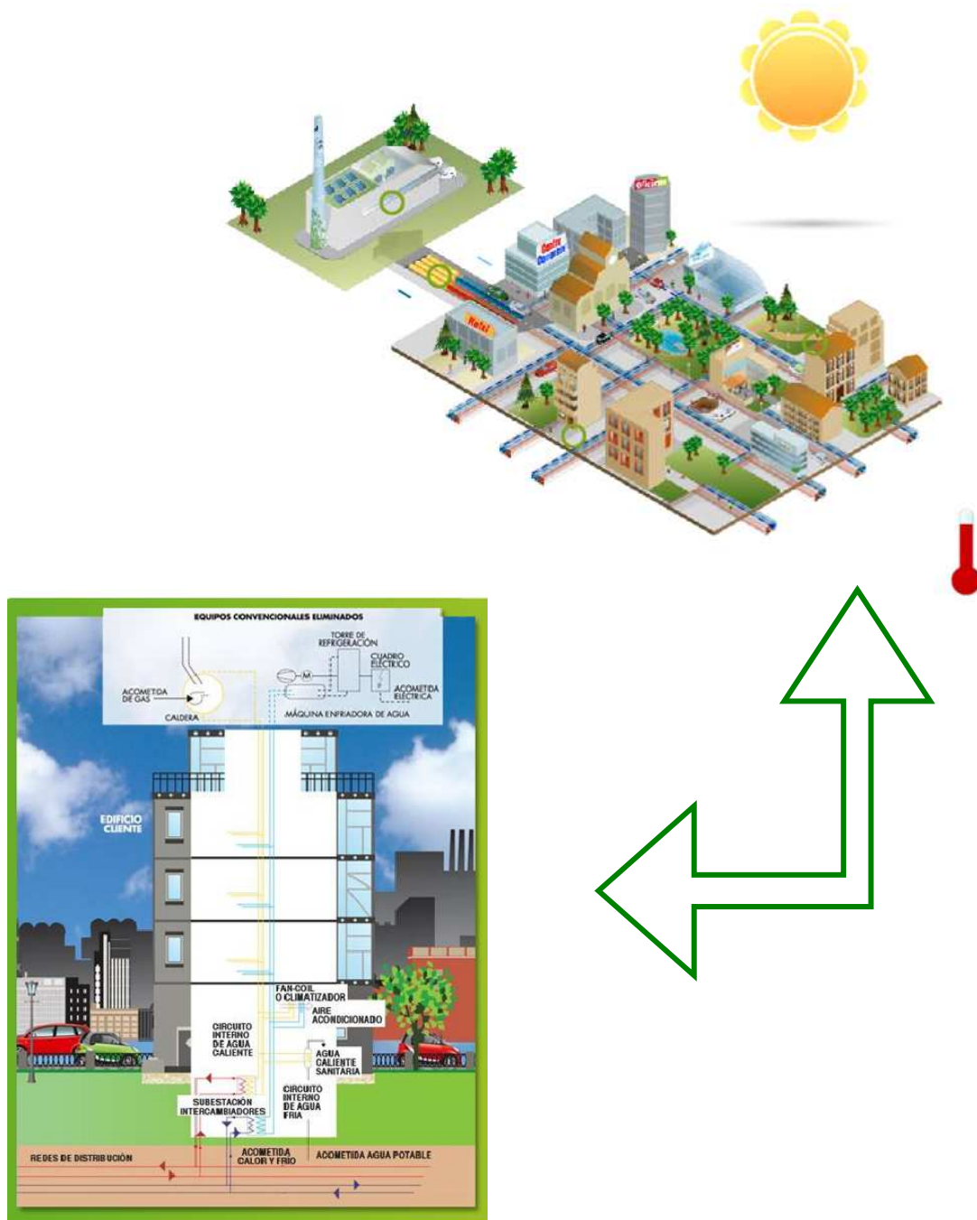
Figura 5-3. Esquema de la Instalación de red de distrito y conexión [Fuente: Districlima]
