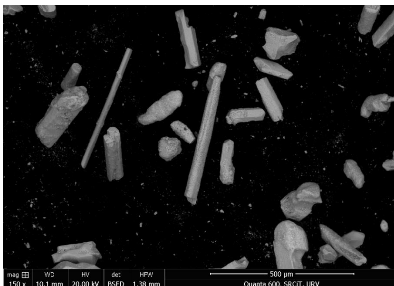
Figura 4.16. Imatge obtinguda per ESEM de \text{DMIMSnI}_3(\text{O}) via carboxilat.
