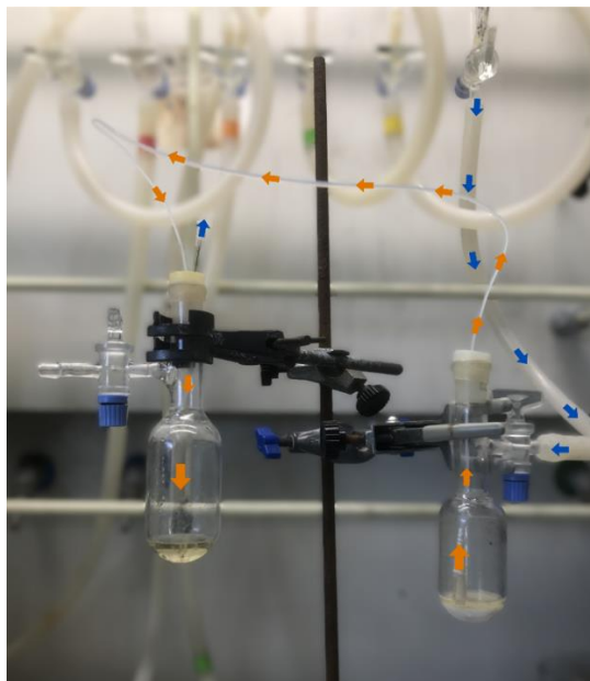
Figura 3.3. Esquema de filtració per cànula. Les fletxes blaves mostren el recorregut de l'argó i les taronges el recorregut del sobrenedant.
