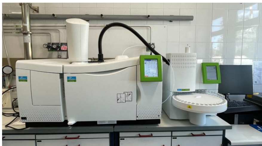
Fig. 7. Cromatògraf de gasos i espectrometre de masses amb mostrejador headspace Perkin Elmer.
