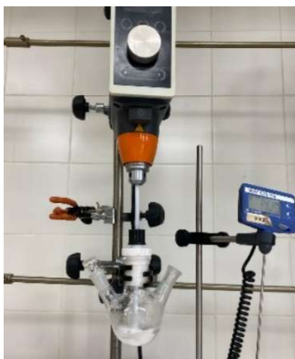
Figura 3 Muntatge emprat per a les síntesis, tant microcàpsules com nanocàpsules.
