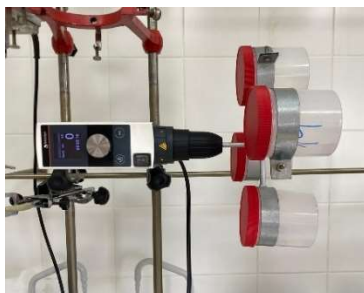
Figura 5 Muntatge del Tambor mecànic experimental per aplicar el suavitzant sobre els teixits de cotó.
