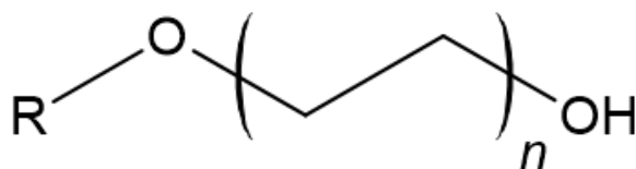
Figura 2. Estructura molecular simplificada dels productes Emulsogen HCO 040 ®, Emulsogen HCO 060 ® i Emulsogen HCW 049 ®.
