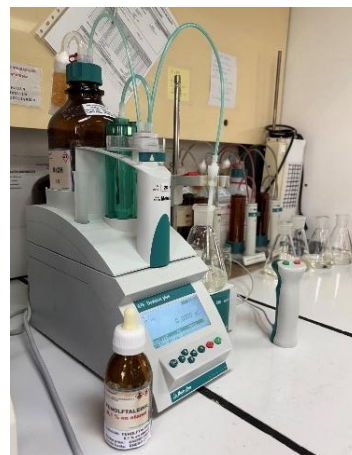
Figura 4. Valoració de la mostra amb una solució de NaOH 1 N.
