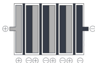
Figura 4. Cel·les bipolars connectades en sèrie
