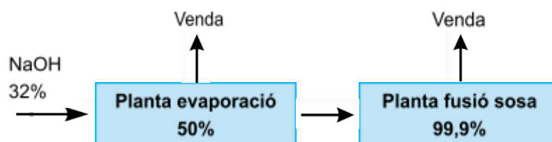
Esquema 2. Processos per concentrar la sosa càustica
