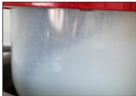
Figura 46: Partícules en suspensió formades durant l'emulsió de la prova 11.
