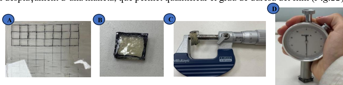
Figura 22: Esquema mesura duresa: A) Film aplicat B) Quadrat C) Mesura gruix D) Mesura duresa Shore A
