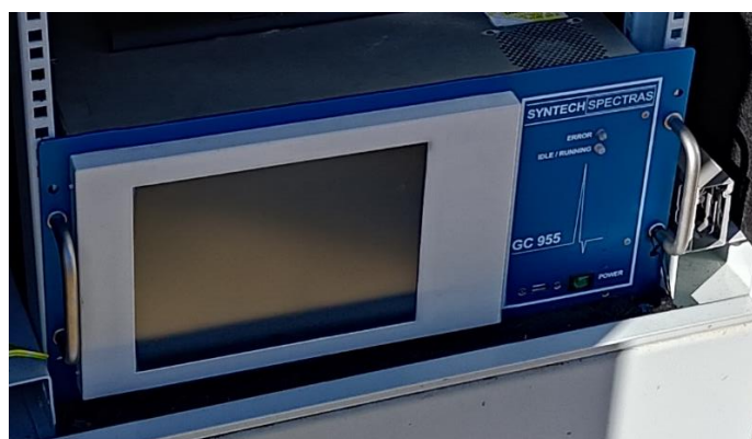
Figura 5.6. Cromatògraf Synspec Spectras GC-955 en el punt de mostreig d'El Morell
