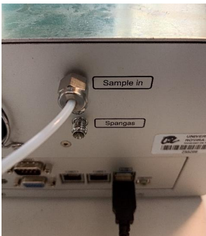
Figura 5.11. Entrada de gas de mostra
