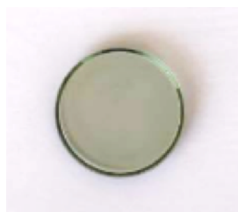
Figura 8.9. Perla de clínker amb bona conformació
