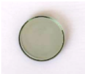
Figura 8. 6. Perla de clínker amb bona conformació
