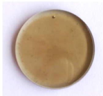
Figura 8.12. Perla de farina de cru amb material no dissolt
