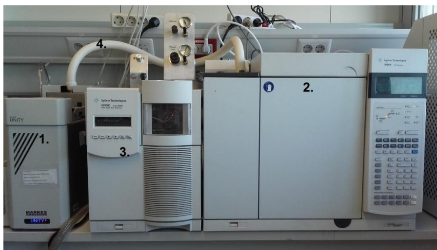
Figura 7. Equip de TD-GC-MS emprat en el treball. 1. Equip de desorció tèrmica, 2. Cromatògraf de gasos, 3. Espectròmetre de masses i 4. Línia de transferència.
