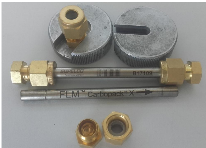
Figura 6. Tubs, taps tipus Brass i les eines emprades per roscar-los. Noti's que la fletxa del tub indica la direcció de mostreig.
