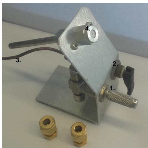
Figura 8. "Calibration solution Loading Ring" utilitzat en el procés de fortificació dels tubs. 1. Regulador de flux, 2. Vàlvula d'agulla, 3. Conducte del gas portador i 4. Sèptum.
