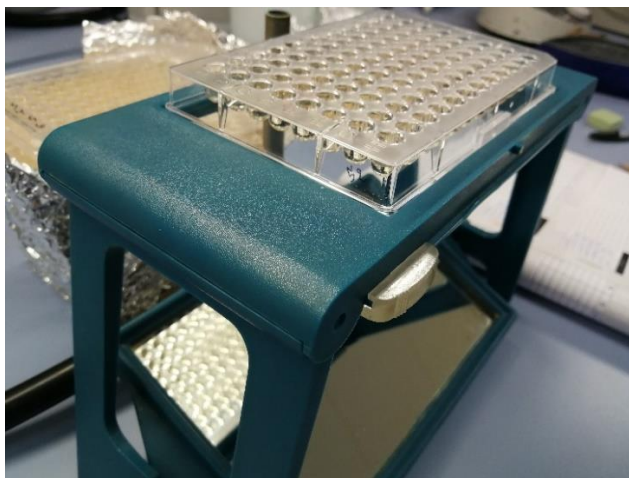
Figura 6. Espejo invertido para la lectura de concentraciones mínimas inhibitorias en microplacas.
