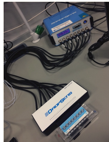
Figura 9. Elèctrodes connectats al potenciòmetre mitjançant la interfície.
