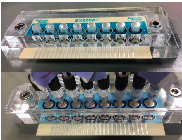
Figura 8. Imatge superior: Elèctrodes dins la cel·la de PMMA. Imatge inferior: Elèctrodes col·locats en la cel·la de fluídica.
