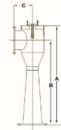
Figura 4.2.4.1. Esquema de l' scrubber .
