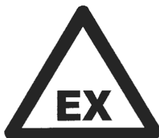
Zona con riesgos de atmósferas explosivas
