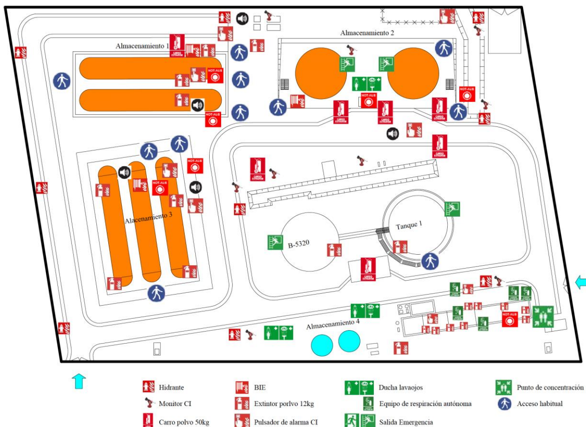
Figura 5.4. Localización equipos de seguridad en el Parque de Tanques Exterior
