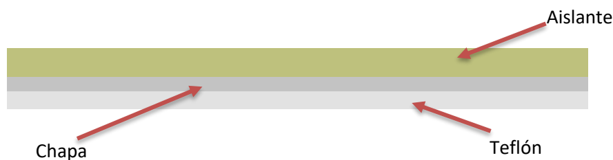
Figura C.5.1. Esquema de las capas de la pared de la tolva con el aislante.
