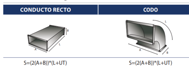
Figura E.1.1. Esquema de los conductos de aspiración de humos.
