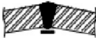
Figura 4.1. Tipo de unión 1 según la norma UW-12.
