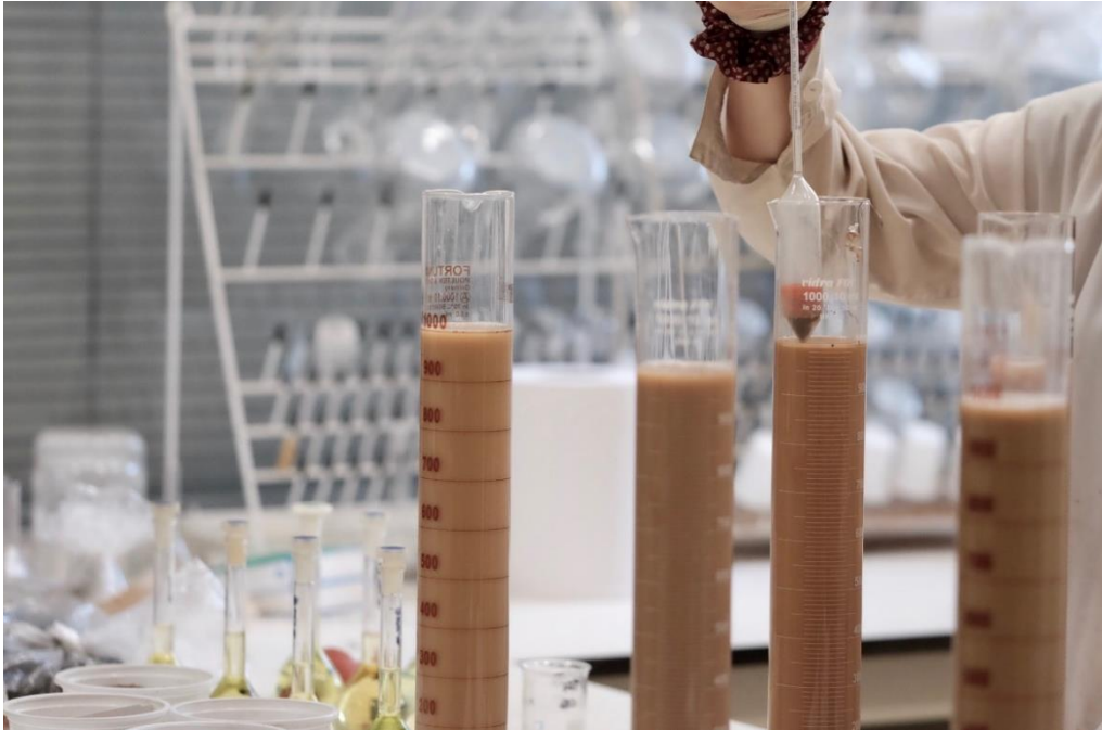
Figura 4.9.3.1. Fotografía de la medición de la densidad mediante el densímetro de Bouyoucos para el estudio de la textura.
