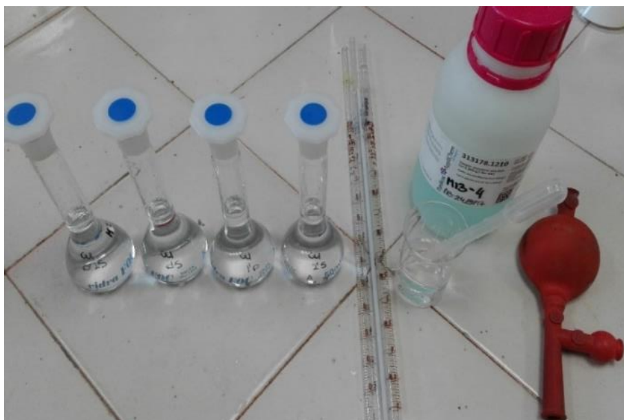
Figura 4.6.1.1. Fotografía de patrones para la obtención de la recta de calibrado antes de la determinación del cobre de las muestras.
