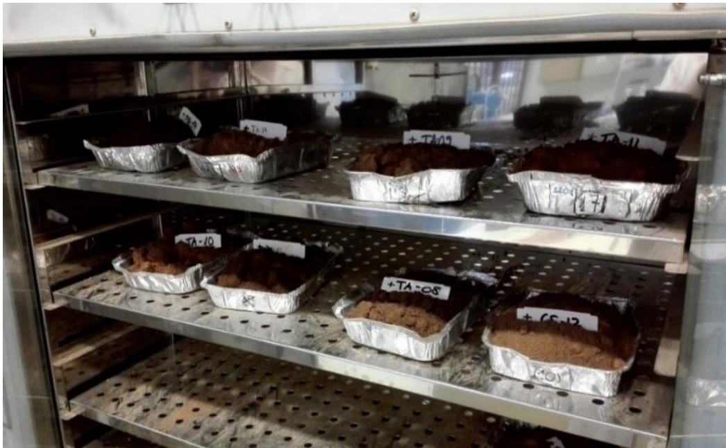
Figura 4.4.2. Fotografía de muestras de tierra en bandejas de aluminio en proceso de secado
