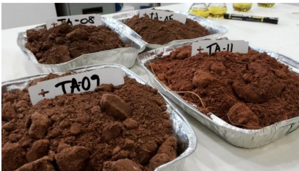
Figura 4.4.1. Fotografía de muestras de tierra en bandejas de aluminio antes del secado.
