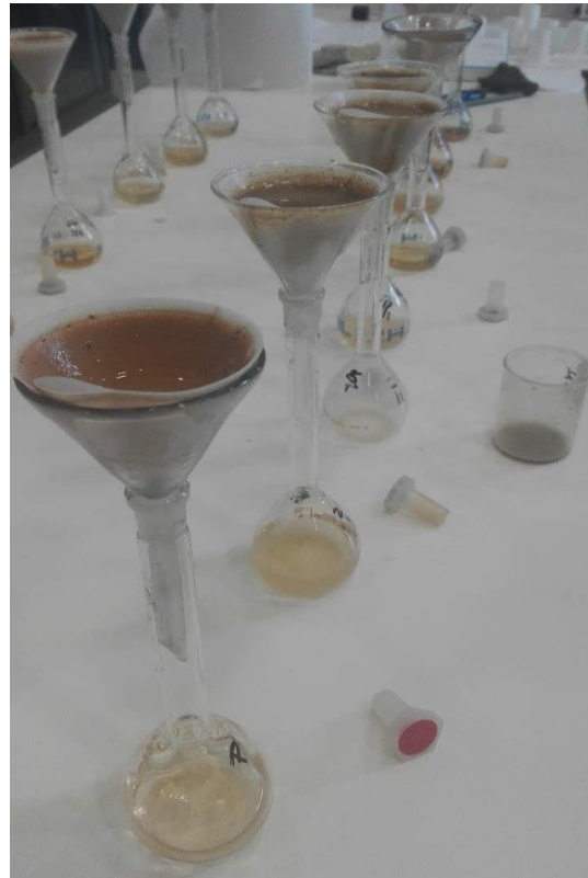
Figura 4.5.1.2.1. Fotografía de la filtración de las muestras tras la extracción del cobre biodisponible mediante el método de EDTA- \text{Na}_2 .
