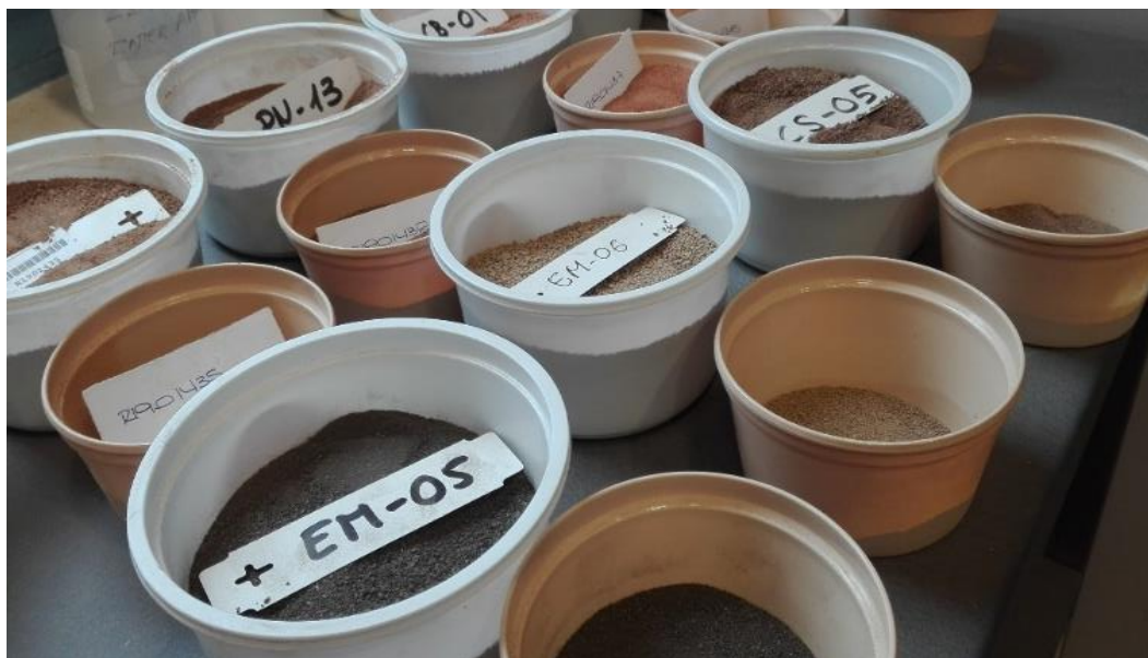
Figura 4.4.3. Fotografía de muestras de tierra secadas y tamizadas
