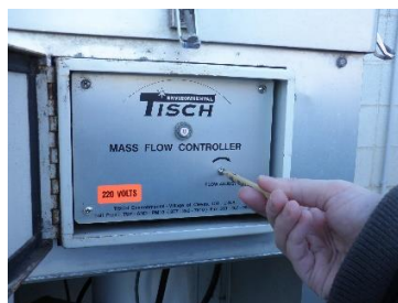
Figura 9. Ajust del cabal en el controlador màssic.
