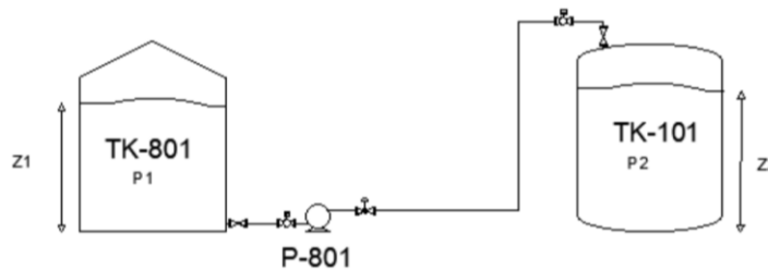
Figura A.4. Esquema de la ubicación de la bomba P-801.
