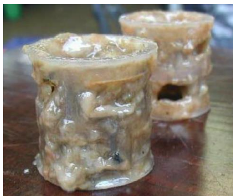
Figura 2.12. Crecimiento microbiano en los anillos de empaquetamiento.
