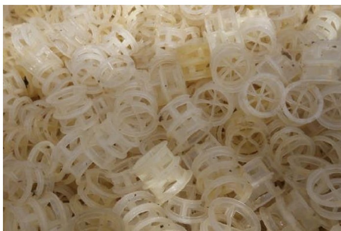
Figura 2.10. Diseño típico del empaquetamiento en una columna de absorción de agua.
