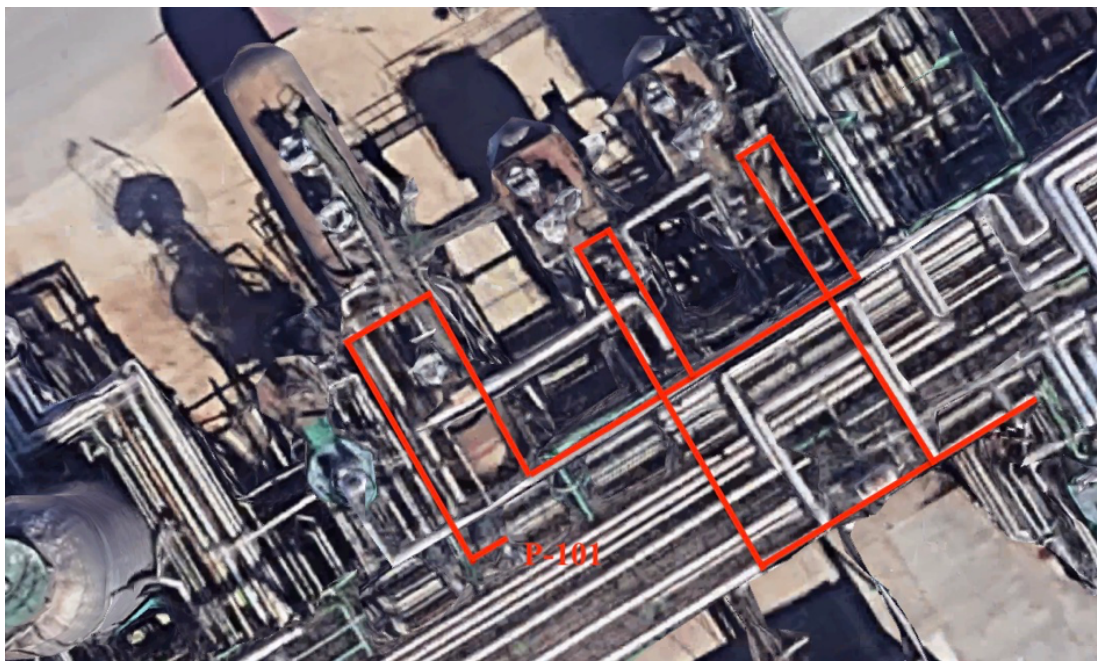
Figura 3.2.1.1. Layout del trazado de tuberías actual
