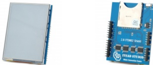
Figura 4. Vistes frontal i posterior de la pantalla LCD amb ranura per a SD usada.
