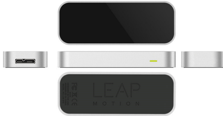
Figura 3.9. Imatge que mostra les diferents perspectives del Leap Motion, Imatge extreta de: http://www.laptopmag.com/reviews/accessories/leap-motion-controller .
