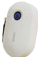
Figura 2.22. Repetidor de señal
