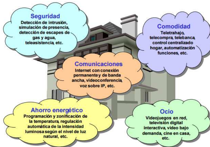
Figura 2.12. Características de una instalación domótica
