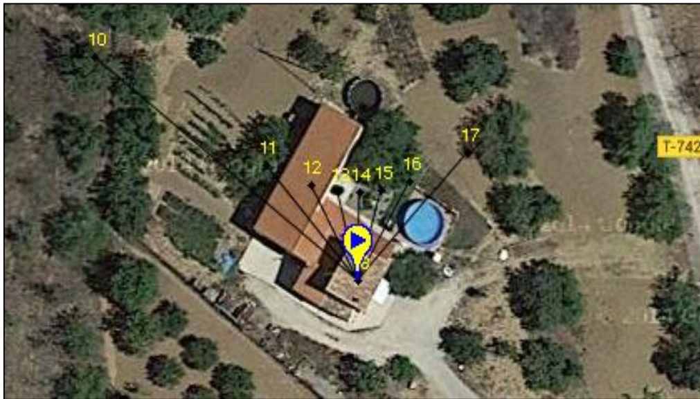
Imagen 32– Sombras de las placas fotovoltaicas ubicadas en el tejado pequeño al tejado grande. [32]
