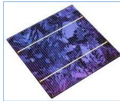
Imagen 8 (izquierda) e Imagen 9 (derecha), células de silicio monocristalino y policristalino, respectivamente. [18]
