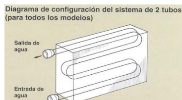
Figura 95: Diagrama disposició sistema dos tubs
