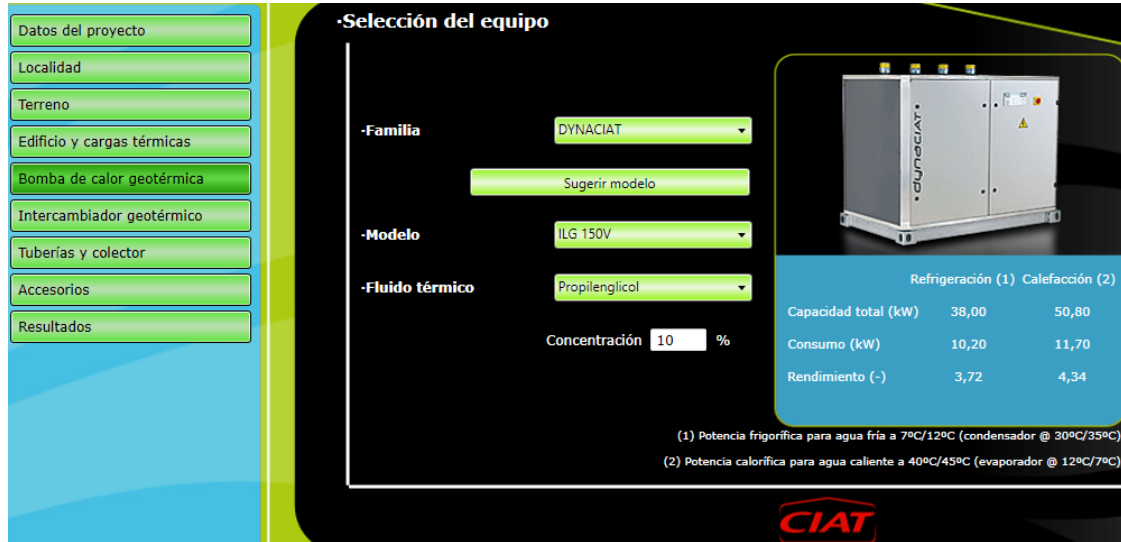
Figura 84: Elecció del tipus de bomba de calor geotèrmica i el fluid tèrmic
