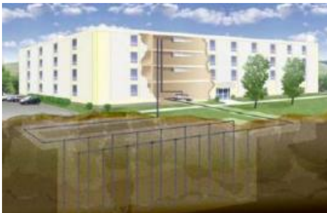
Figura 74: Sistema bucle tancat vertical
