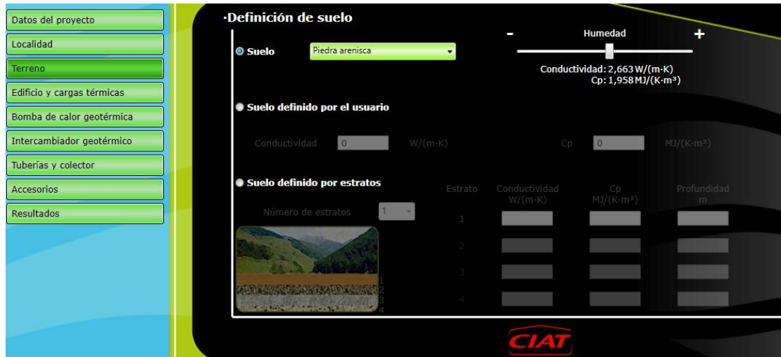
Figura 82: Definir el tipus de sòl on anirà l'intercanviador geotèrmic
