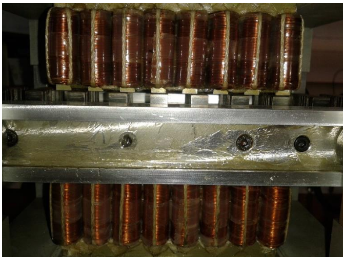
Figura 8 Perfil del motor LSRM a estudiar
