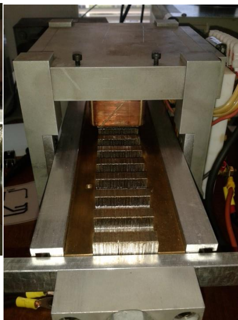
Figura 7 Frontal del motor LSRM a estudiar
