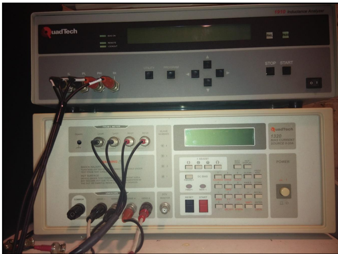
Imatge 7. Analitzador d'inductància, QuadTech 1910 Inductance Analyzer
