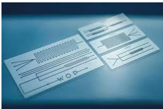
Fig 7 – Ejemplo de chip de microfluidos.
