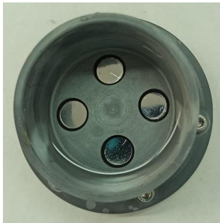
Figura 15. Mostres fixades a la cel·la de quatre per a la segona anodització.
