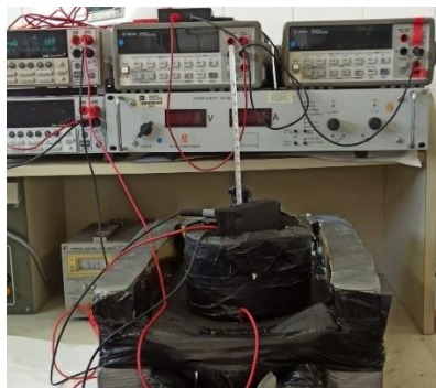
Figura 56. Cel·la connectada a la font i al cooler.
