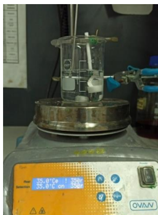
Figura 17. Muntatge de les mostres per un pore widening a 35°C.
