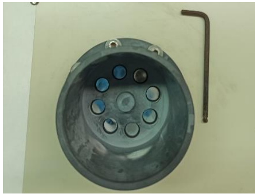
Figura 9. Mostres fixades en la cel·la de 8.
