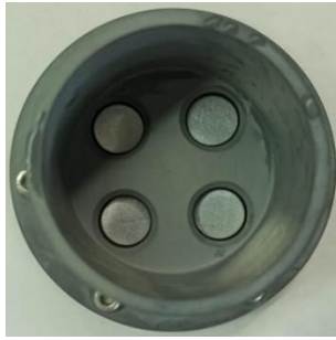
Figura 5. Plaques d'alumini subjectades en la cel·la de 4.
