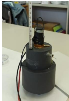
Figura 6. Agitador que es connecta al ànode de la font.
