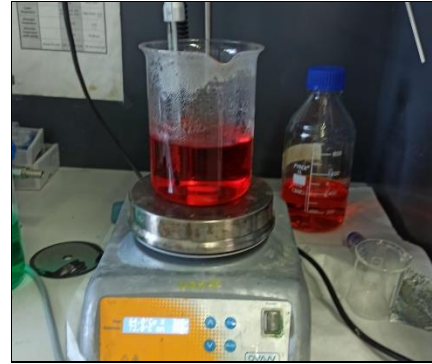
Figura 11. Solució d'àcid cròmic a 70 °C per l'etching.
