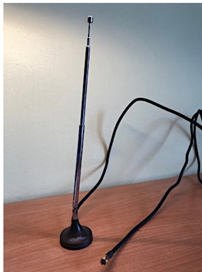
Figura 47. Antena extensible utilizada en el proyecto.
