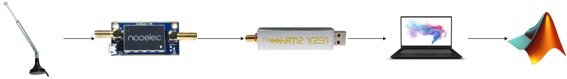
Figura 36. Esquema del montaje del receptor de señales VOR.
