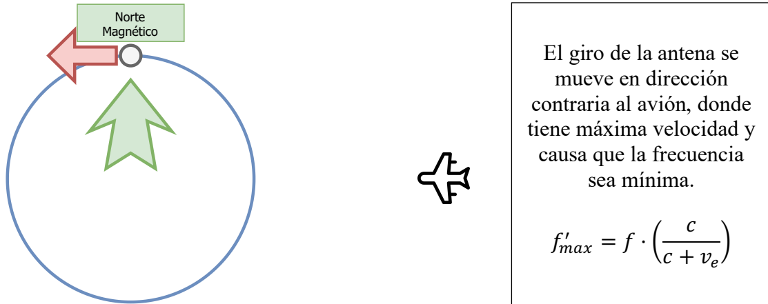
Figura 18. Desviación de la frecuencia recibida por un avión en el radial 090 de la señal variable apuntando hacia el radial 000 o 360.
