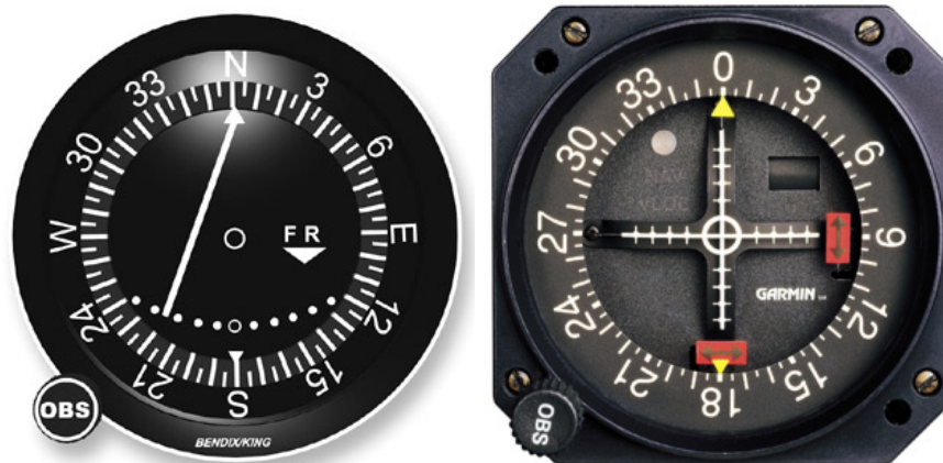
Figura 28. Instrumentos de indicación de desviación OBI.
