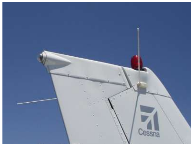
Figura 45. Antenas VHF para la recepción de señales VOR en el fuselaje de un avión.
